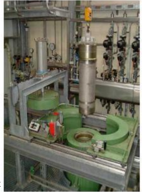
Şekil 2 : Seleli, 1000 bar kapasiteli ekstarktör
